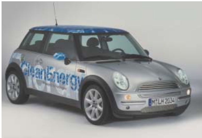
För att visa att systemet också passar bra i mindre bilar har BMW byggt en gasbil i en MiniCooper.
