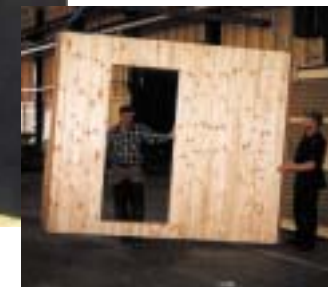
Byggelementen sammansätts av massivt trä i fabriken i Skänninge
