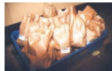
Påsen vägs innan torkning och efter. Automatiskt fångas informationen med hjälp av streckoden. Lokalt på anlägg- ningen sker sedan automatiskt databehandling och priset för leveransen utfaller direkt.
