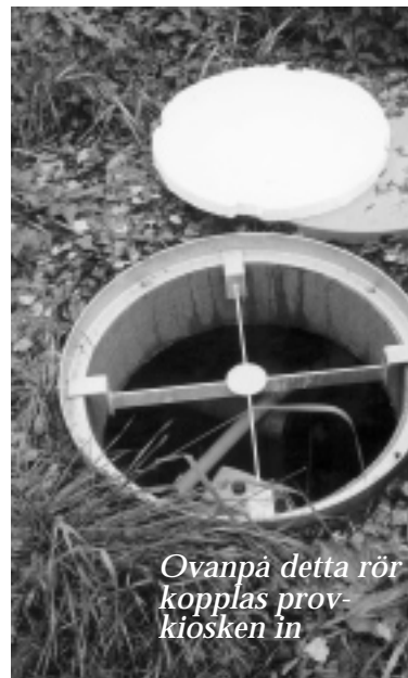
Provtagnings systemet. En flaska fylls per dag genom tidsstyrd automatik.
