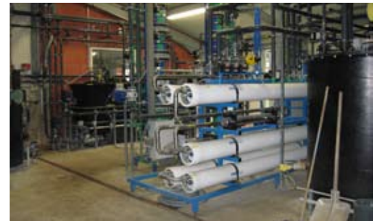
Tecnologia di filtrazione con membrane del digestato (ENVITEC)
