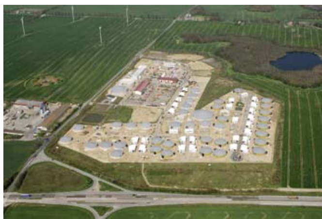
L'EnviTec Biogas ha costruito a Penkun in Germania il parco biogas più grande del mondo. E' operativo da novembre 2007 con una capacità di 20 MWel.
