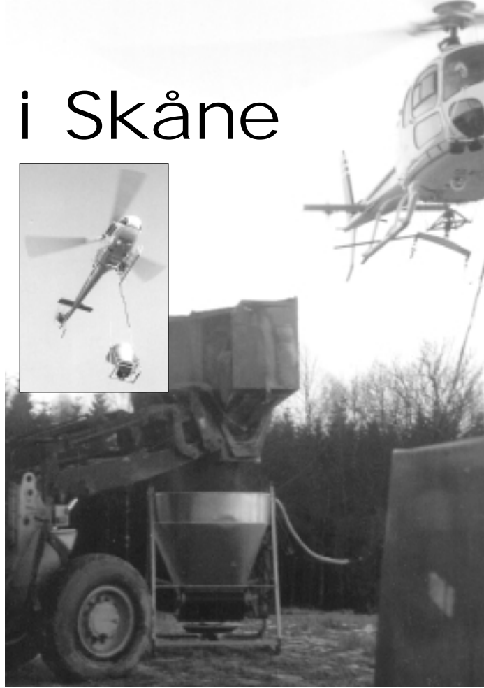
Askspridning kan ske från luften med helikopter. Helikoptern "ryttlar" under påfyllningen av behållaren.
