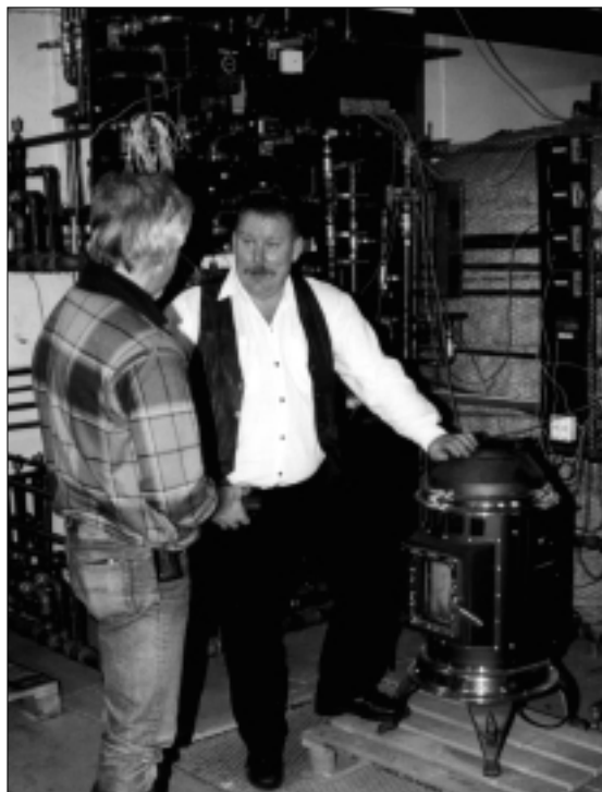
Bengt-Erik Löfgren visar Thelin, en liten billig amerikansk pelletskamin med bra data. Ett skäl är att den har ett litet förbränningsrum vilket bidrar till låga luftöverskott.
