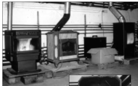
Två uppkopplade brinnande kaminer, Envirofire och EcoTyren, bredvid EcoTec Tyr syns det svarta fristående pelletsförådet. Mellan dem står en irländsk vedkamin från Waterford, avsedd för halv-metersved och som är utrustad med katalysator. Den visas på lilla bilden.
