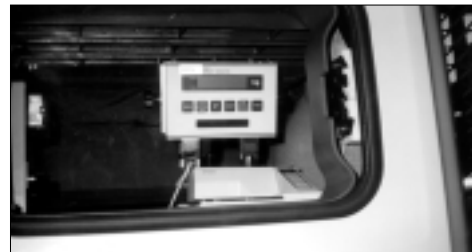
Väginstrument för vägning och utskrift av rätt mängd träpellets
