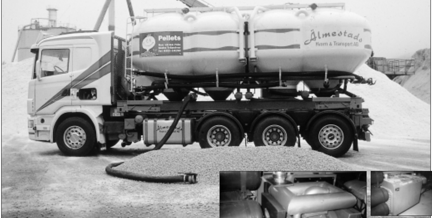
Kompressor för tömning av pellets. Med och utan isolerhuv. Dämpar buller till cirka 80 decibel.
