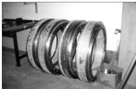
Pelletshallen med synligt kollerhjul i en press samt fyra stycken uttagna ringmatriser.
