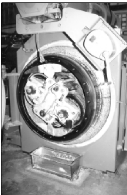
Pelletshallen med synligt kollerhjul i en press samt fyra stycken uttagna ringmatriser.
