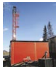
Stokerbrännaren från Arimax klarar flera typer av bränslen.
