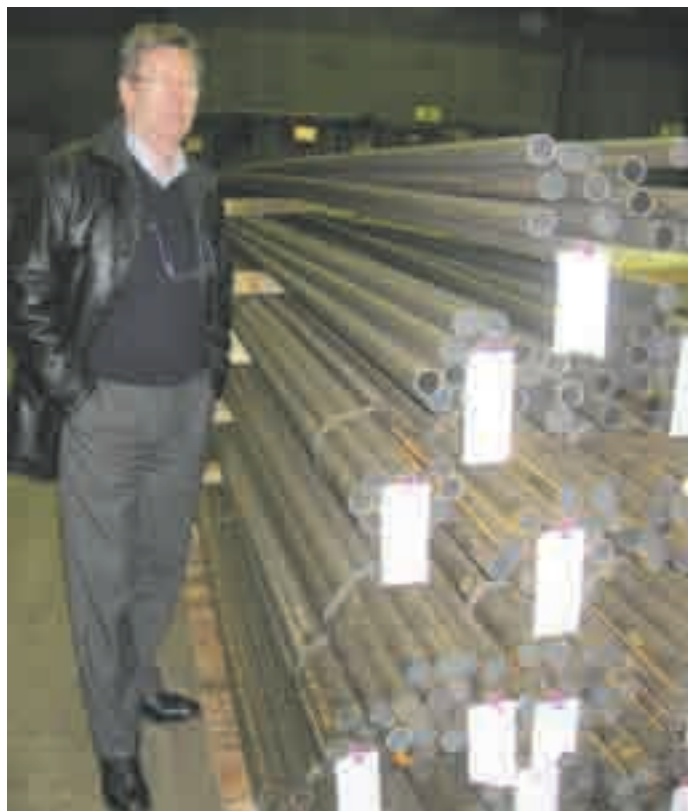
I en hall finns lagret av rör som används till pannväggarna. Bosse xxxxx visar tuber från en tillverkare i Tyskland.
