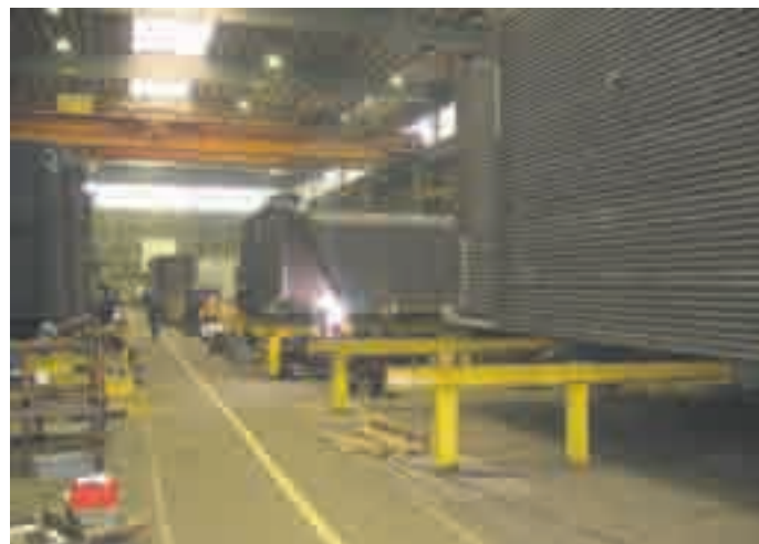
Pannväggar svetsas ihop i den stora hallen.
