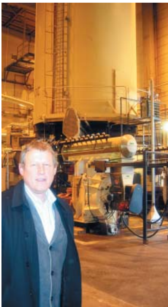
I maskinhallen finns bland annat två kvarnar som mal det torkade spånet innan det går in i någon av de fyra pelletspressarna.
