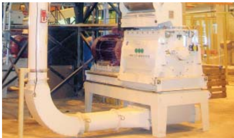
I maskinhallen finns bland annat två kvarnar som mal det torkade spånet innan det går in i någon av de fyra pelletspressarna.
