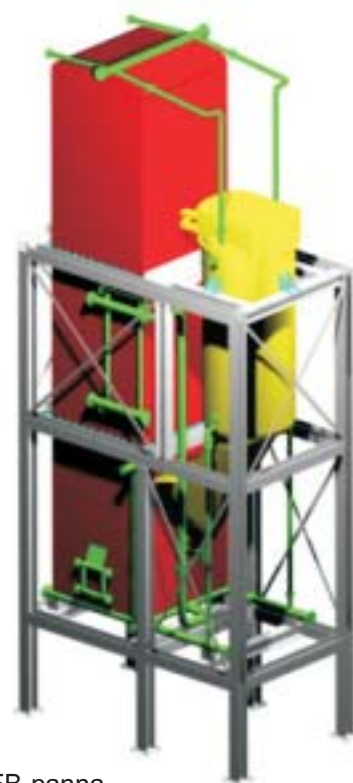
Ny FB-panna speciellt utvecklad för avfallseldning i små och medelstora tillämpningar.
