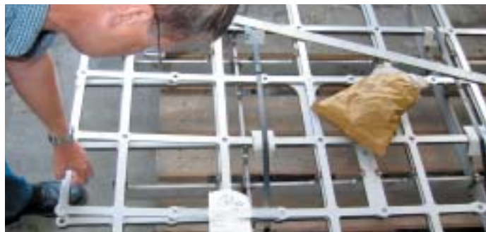
Detaljer till ett elfilter är skurna med vatten av en underleverantör.
