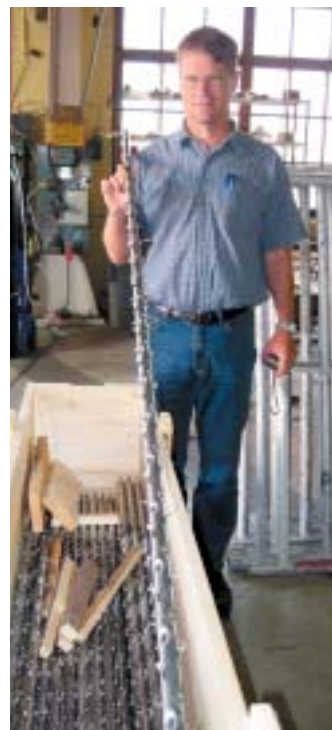
Tomas Borg visar elektrostaven som finns mitt i rören i elfiltret.
