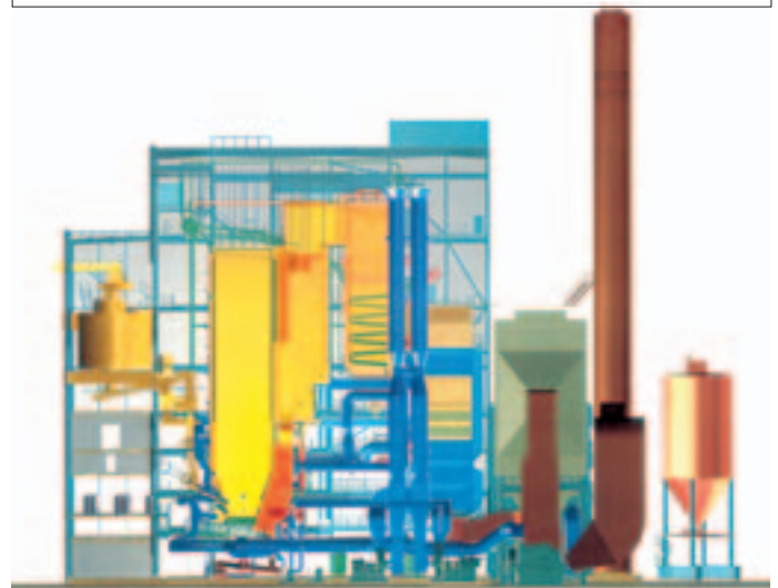
Illustration över den nya anläggningen med bränslemottagningen till vänster CFB-pannan i mitten och rökgasrening till höger.
