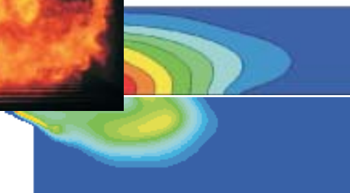
Foto av träpulverflamma i provugn, jämförelse av mätt och modellerad flamma
