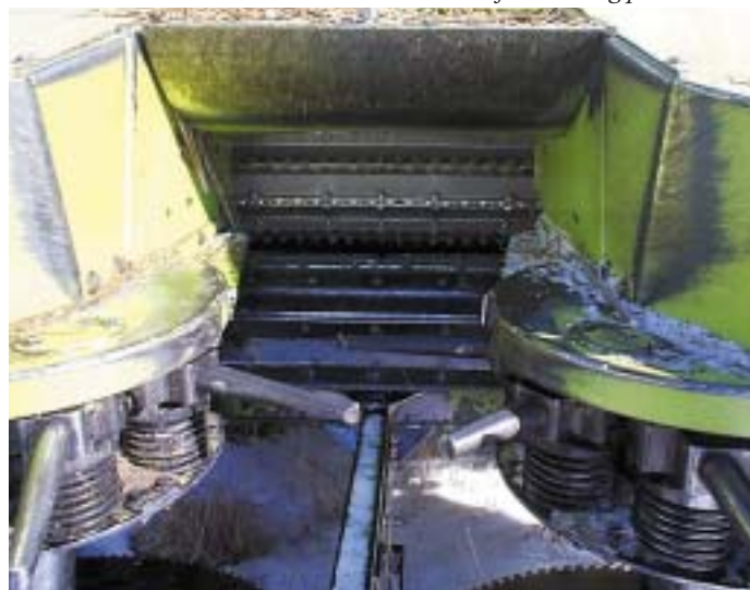
Flödet av salix in i skördaren bestäms genom mätning av avståndet mellan de två inmatningsvalsarna i mitten av bilden.
