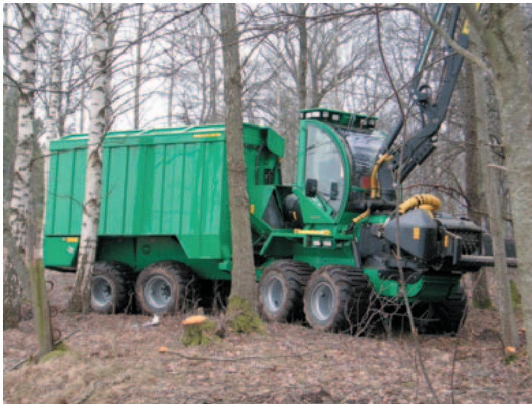
Den mellanstora flisskördaren har ett munstycke som kan vinklas i 90 grader åt båda hållen.
