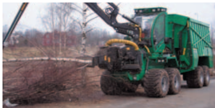
Skördaren klarar träd med en diameter upp till 35 centimeter
