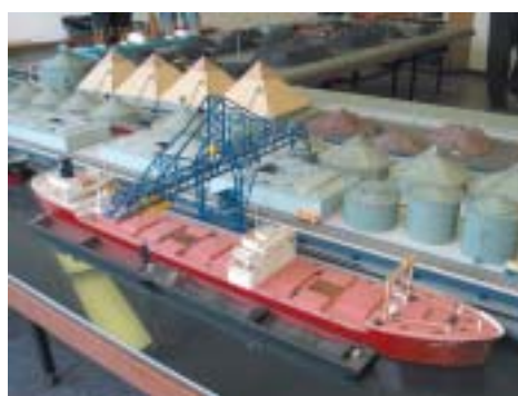
Modellen visar en del av hamnområdet som företaget EBS -bulkservice disponerar. En av de två stora på räls gående kranarna lossar eller lastar fartyget. Lasten läggs i en mindre utanpåliggande båt eller direkt till ett lager genom taket alternativt som i detta fall på det långa transportband som löper längs kajen och sedan tillbaka inmanför till de stora pyramidsilona.
