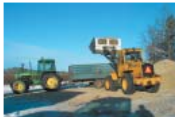
Intransport av flis sker med traktorsläp. Skördaren lägger flis på mark och hjullastaren lastar med skopa.
