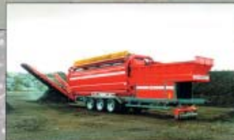
Trumsikt TS-2500 Sikt för två eller tre fraktioner Stor inlastningsficka Automatisk framflyttning Hydrauliska stödben Enkelt trumbyte
