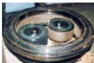
Ringmatrispress med sina kollerhjul inuti. Spånet pressas av kollerhjulen genom småhål i ringmatrisen.
