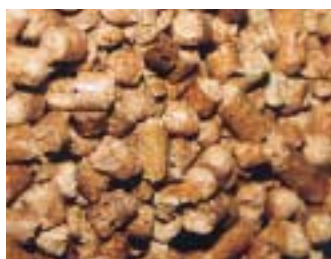
Pelletsen har vanligen diametern 6 eller 8 mm och längden 10 till 20 mm.
