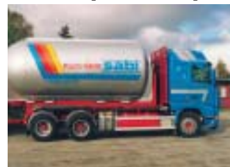
Bulktransportbil, bilen kör fram intill huset och föraren kopplar en slang till förrådet och böasder in pelletsen. Det kan ta uppemot en halvtimme. Bilen kan stanna 10 - 20 meter från förrådet.
