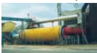
Trumtorken hos Såbi i Vaggeryd. Torkningen sker med rökgaser.
