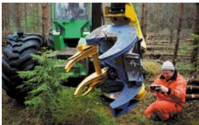
Med en skicklig maskinförare har aggregatet en kapacitet på 200-280 stammar per timme.
