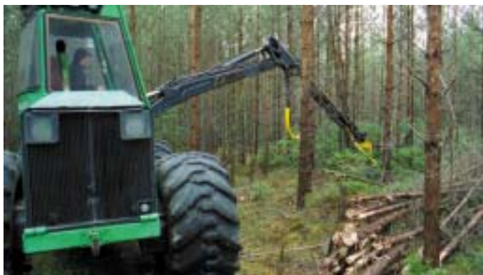
Med stickvägar med 20 meters mellanrum och med en fällarm på 11 meter kan gallring genomföras på ett effektivt sätt.
