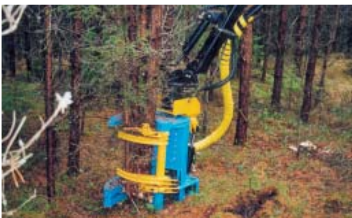
Aggregatet kan ackumulera 5-8 stammar. Ett utbytbar knivblad klarar att klippa stammar upp till 25 centimeter i diameter.
