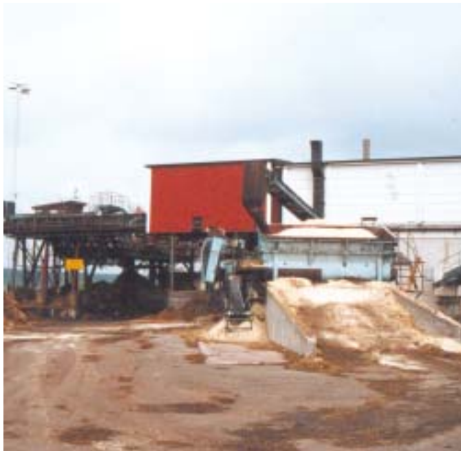
Karl Hedins Såg i Karbenning tar emot cirka 370 000 fast kubikmeter med timmer per år. Det gör sågverket till ett av de större i Sverige. Ovan till vänster: Timret barkas, barken rivs och används som bränsle till torkarna. Ovan till höger: Sten-Åke Andersson, tekniskt ansvarig på Karl Hedin AB.
