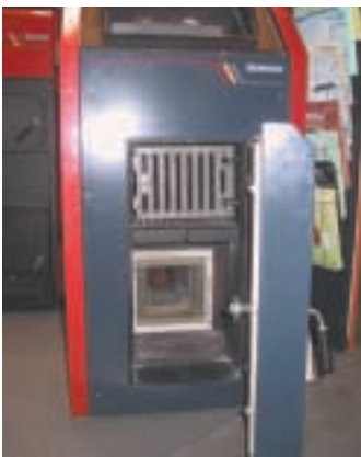
Kenneth Olsson visar Euronoms ved-pelletspanna med inbyggd brännare.
