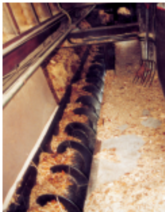
En 14 meter lång matarskruv i ett stycke av 25 mm cortenstål.
