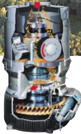
Kahlpressen som används hos Sydpellets i Traryd. Två stycken på vardera 2,5 ton finns installerade.
