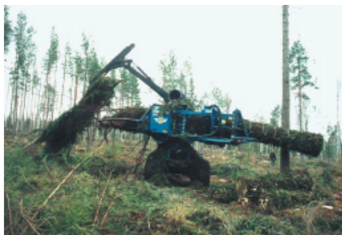
Fiberpac är en småländsk uppfinning. Ris och småträdd matas in i ena ändan, pressas och binds i en följd. Ut kommer i andra ändan 3,2-meterskorvar. Varje buntad bal innehåller 1,5 kubik. Tjugo buntar motsvarar den mängd energi som krävs för uppvärmning av en normalvilla, eller tre kubik olja á 5.400:-/kubikmeter.
