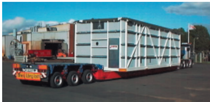
De kompletta eldningsenheter för fastbränsle och olja levereras i egentillverkade pannhus. På bilden ovan levereras en 2000 kW-s biobränslecentral.
