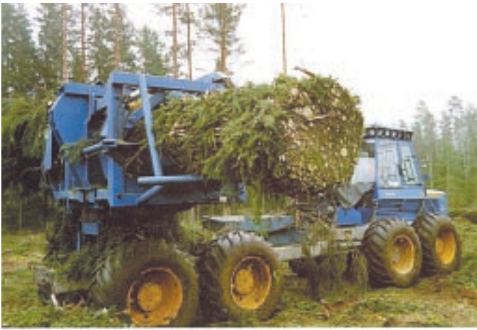
Fiberpac 370 väger ca 6 ton. Komprimeringsutrustningen kan monteras på en medelstor eller stor skotare.
