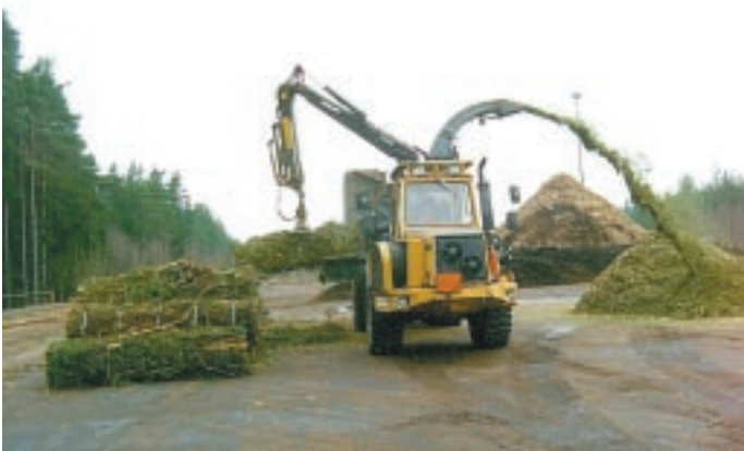
Bruks 1004 CT, trumbugg monterad på dumperchassi. Vid 8 månaders drift i tvåskift och TU 60 % uppgår produktionskapaciteten till ca 200 000 m 3 s per år.
