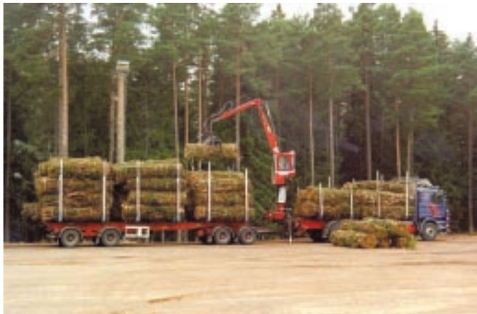
Konventionellt rundvirkesfordon lastar ca 66 buntar, 15 per trave på släpet och 10-11 buntar per trave på bilen. En massavedsbit läggs nederst på sidan i traven så att inte bunten hänger ned över lastsäkringsutrustningen.
